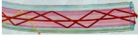
Figura 2.2: Fenómeno de la reflexión total interna en fibras ópticas [3].
