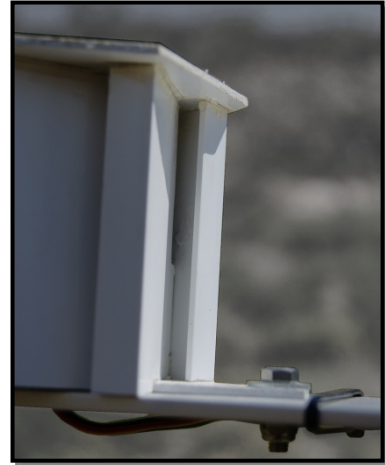
Figura 3.7.13 Abertura lateral de la estructura protectora de sensores.
