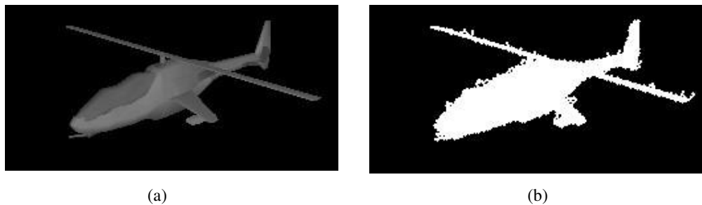
Figura 4.6: (a) Imagen AH-84.bmp . (b) Imagen umbralizada con margen_{umbraliz.} = 5 .
