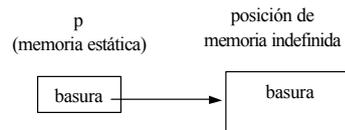
La variable anónima debemos crearla después mediante una llamada a un procedimiento de asignación de memoria -dinámica- predefinido. El operador `new` asigna un bloque de memoria que es el tamaño del tipo del dato apuntado por el puntero. El dato u objeto dato puede ser un `int`, un `float`, una estructura, un array o, en general, cualquier otro tipo de dato. El operador `new` devuelve un puntero, que es la dirección del bloque asignado de memoria. El formato del operador `new` es:
