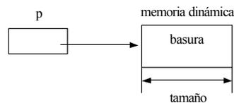
Para saber el tamaño necesario en bytes que ocupa una variable de un determinado tipo, dispondremos también de una función predefinida: `sizeof(Tipo)` que nos devuelve el número de bytes que necesita una variable del tipo de datos `Tipo`. Podemos usar este operador con datos más complejos:
