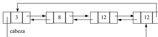
Existe una operación de insertar y eliminar (borrar) en cada dirección. En caso de eliminar un nodo de una lista doblemente enlazada es preciso cambiar dos punteros. Por ejemplo, para insertar un nodo a la derecha del nodo actual tenemos que asignar cuatro nuevos punteros, como puede comprobarse gráficamente:
