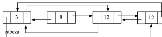
Una lista doblemente enlazada con valores de tipo int necesita dos punteros y el valor del campo datos:
